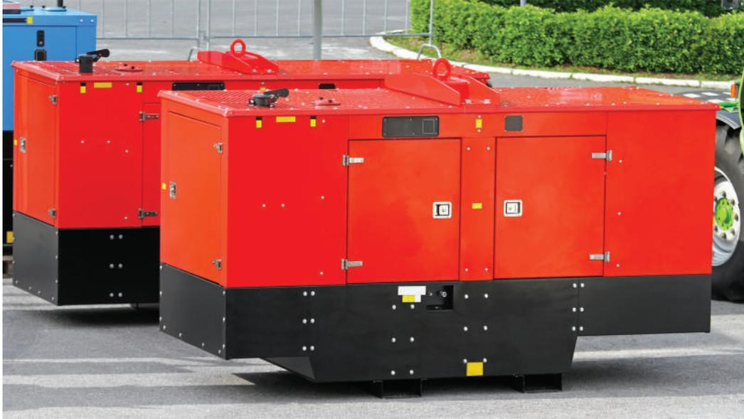
محطات التوليد ذات الاحتراق الداخلي هي عبارة عن آلات تستخدم الوقود السائل (Fuel Oil) حيث يحترق داخل غرف احتراق بعد مزجها بالهواء بنسب معينة، فتتولد نواتج الاحتراق وهي عبارة عن غازات على ضغط مرتفع تستطيع تحريك المكبس كما في حالة ماكينات الديزل أو تستطيع تدوير التوربينات حركة دورانية كما في حالة التوربينات الغازية .
